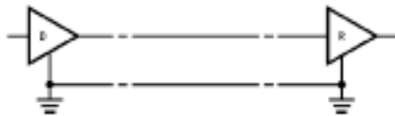
Figura 21. Aplicación típica de EIA/TIA-232-E.
