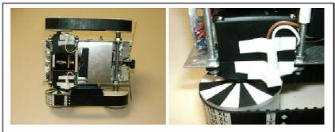
Figura 9. Vista inferior del robot y vista detalle de la rueda
