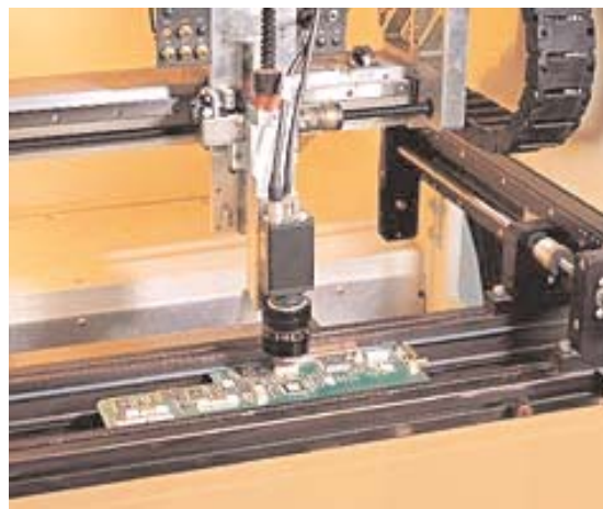
Foto 1. Un sistema de tres ejes usa un controlador de movimiento para mover la cámara a la misma velocidad que la cinta transportadora para inspeccionar las placas sin necesidad de
