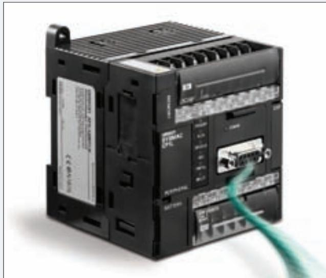
■ El CP1L de Omron es un PLC compacto de muy pequeñas dimensiones con 12 E/S y hasta 160 con expansión, servidor OPC y opción de distintos buses de campo
