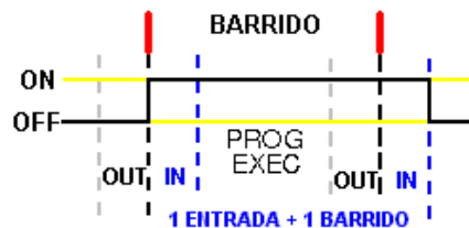
Figura 5. Menor tiempo posible para que la entrada sea revisada por el PLC.
